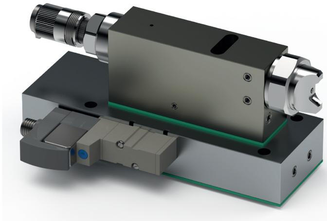
Die Sprühbalken mit Sprühventilen der Baureihe MKD-IVN sind konzipiert, um eine Verkettung von Sprühventilen ohne störende Versorgungsschläuche vornehmen zu können. Die Ventile werden über Anschlussplatten auf ein Aluminiumprofil aufgeschraubt. Dadurch sind die Düsenabstände absolut variabel ausführbar. Die Ansteuerung der einzelnen Spritzapparate erfolgt über direkt angeflanschte Magnetventile.
